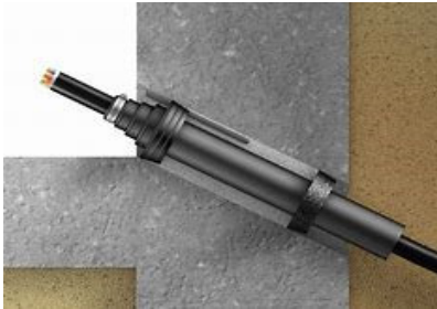
Beispiel 1: Schräg angesetzte Kernbohrung
